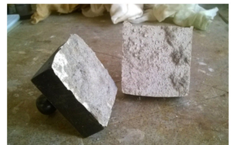
ОПРЕДЕЛЕНИЕ АДГЕЗИОННОЙ ПРОЧНОСТИ РАЗРАБОТАННЫХ СТИРОЛ-АКРИЛОВЫХ ПОКРЫТИЙ К БЕТОННОЙ ПОВЕРХНОСТИ
