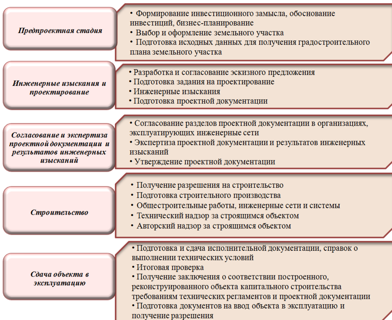
Рис. 16. Стадии реализации инвестиционно-строительного проекта
