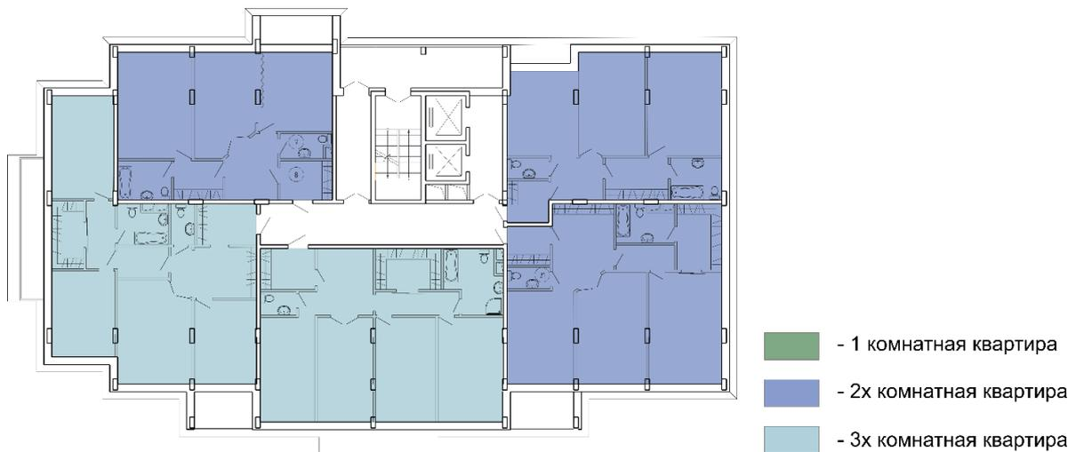
Рис. 4.7. План 1 жилой секции на отметке 8,40 м. Функциональная схема плана 1 секции
