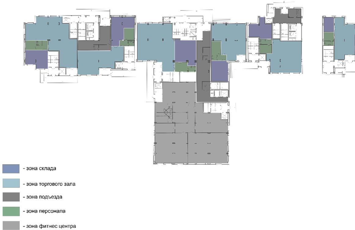
Рис. 4.4. Функциональная схема плана на отметке 0,00. Экспликация помещений
