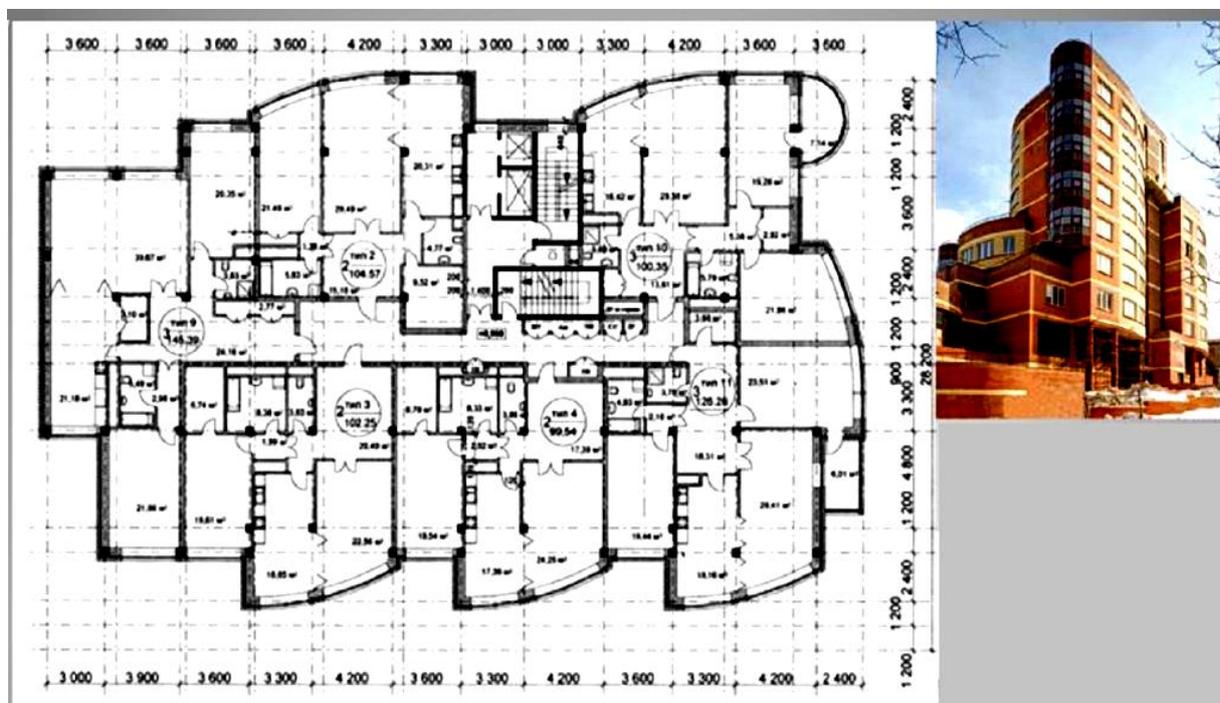
Рис. 5.5. Жилой дом с монолитным каркасом и колоннами квадратного сечения
