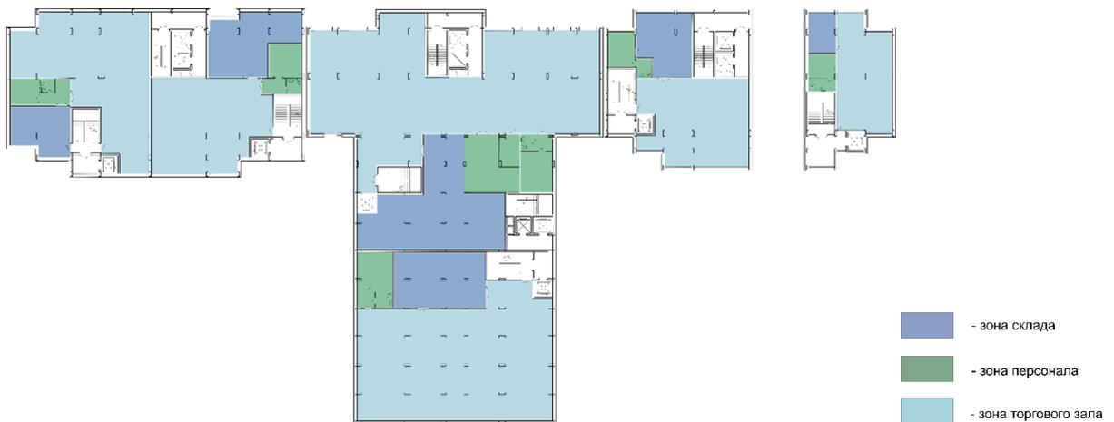
Рис. 4.6. Функциональная схема плана на отметке +4,20 м
