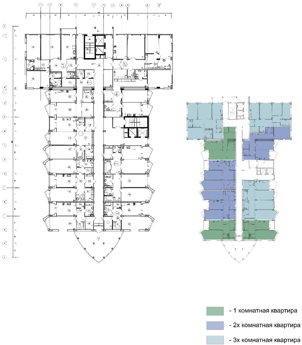
Рис. 4.8. План 2 жилой секции на отметке 8,40 м. Функциональная схема плана 2 секции
