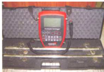
Рис.10.5. Общий вид инклинометра фирмы SISGEO (пример отечественного применения)
