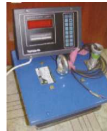
Рис.10.6. Примеры установки датчиков для определения усилий в арматуре различных конструкций и общего вида измерительных приборов: а – тензометрические датчики, смонтированные на арматуру плиты в двух направлениях перед бетонированием; б – струнный датчик для определения усилий в бетоне буронабивной сваи; в – тензодинамометр и вторичный прибор для определения усилий в бетоне забивной сваи
