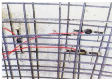
Рис.10.6. Примеры установки датчиков для определения усилий в арматуре различных конструкций и общего вида измерительных приборов: а – тензометрические датчики, смонтированные на арматуру плиты в двух направлениях перед бетонированием; б – струнный датчик для определения усилий в бетоне буронабивной сваи; в – тензодинамометр и вторичный прибор для определения усилий в бетоне забивной сваи
