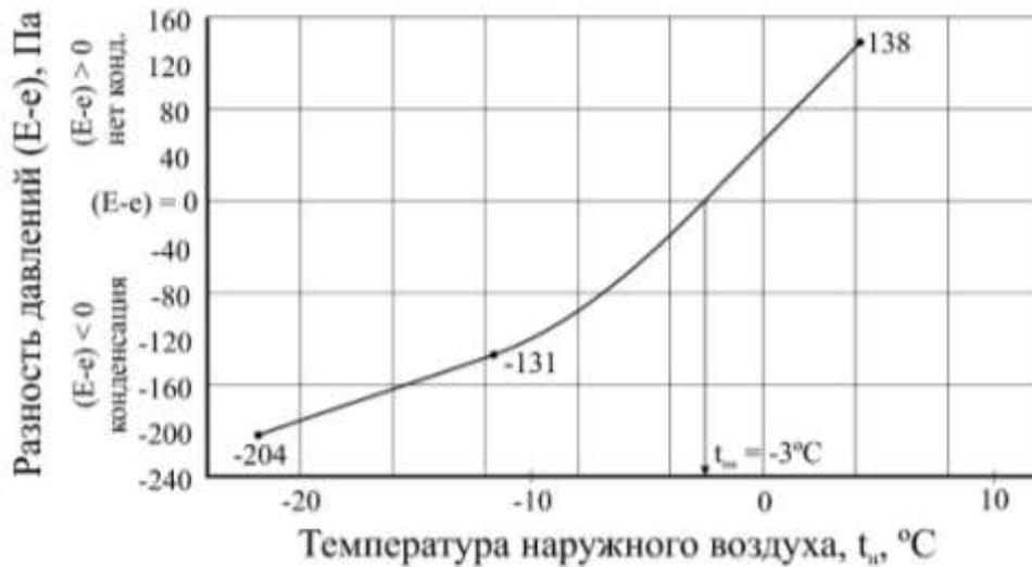
*Рис. 3.5. Определение температуры начала конденсации  $t_{нк}$  в расчетном сечении трехслойного ограждения*
