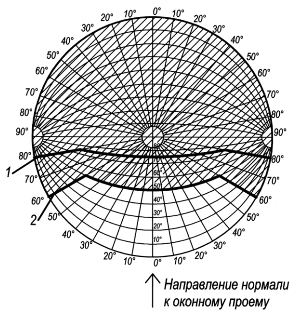
Рис. 4.32. Картограмма затенения светопроема окна (1) и лоджии (2)
