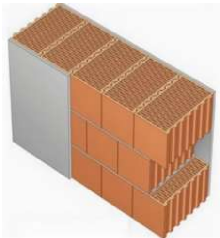
Рис. 3.2. Однослойные (однородные) каменные конструкции наружных стен: а – оштукатуренный керамический блок, б – керамический блок, облицованный лицевым кирпичом
