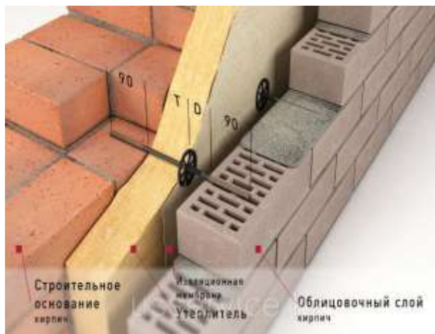
Рис. 3.13. Гибкие (а) и жесткие (б) связи соединения облицовочного и конструктивного слоев
