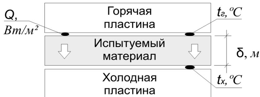
Рис. 2.2. Принципиальная схема прибора
