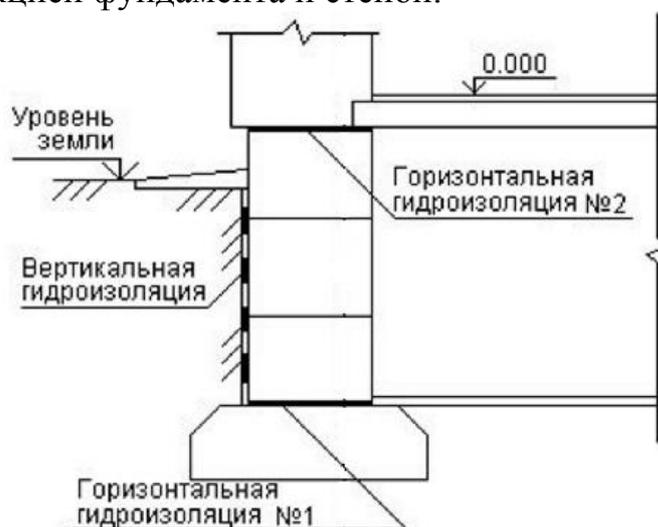
**Рис. 4.2.** Горизонтальная отсечная гидроизоляция
