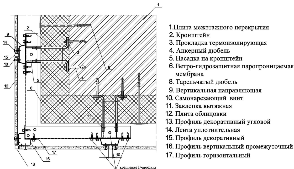
Рис. 44. Внешний угол здания. Разрез Ж-Ж (вентфасад)
