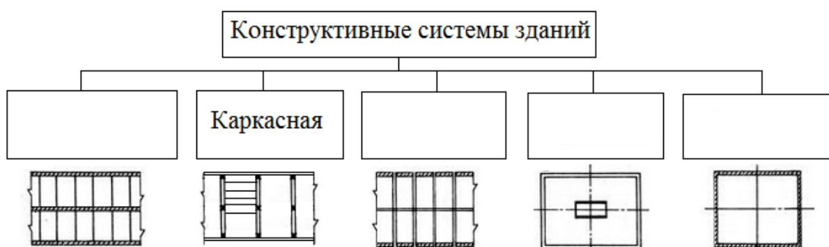
Рис. 10. Конструктивные системы зданий
