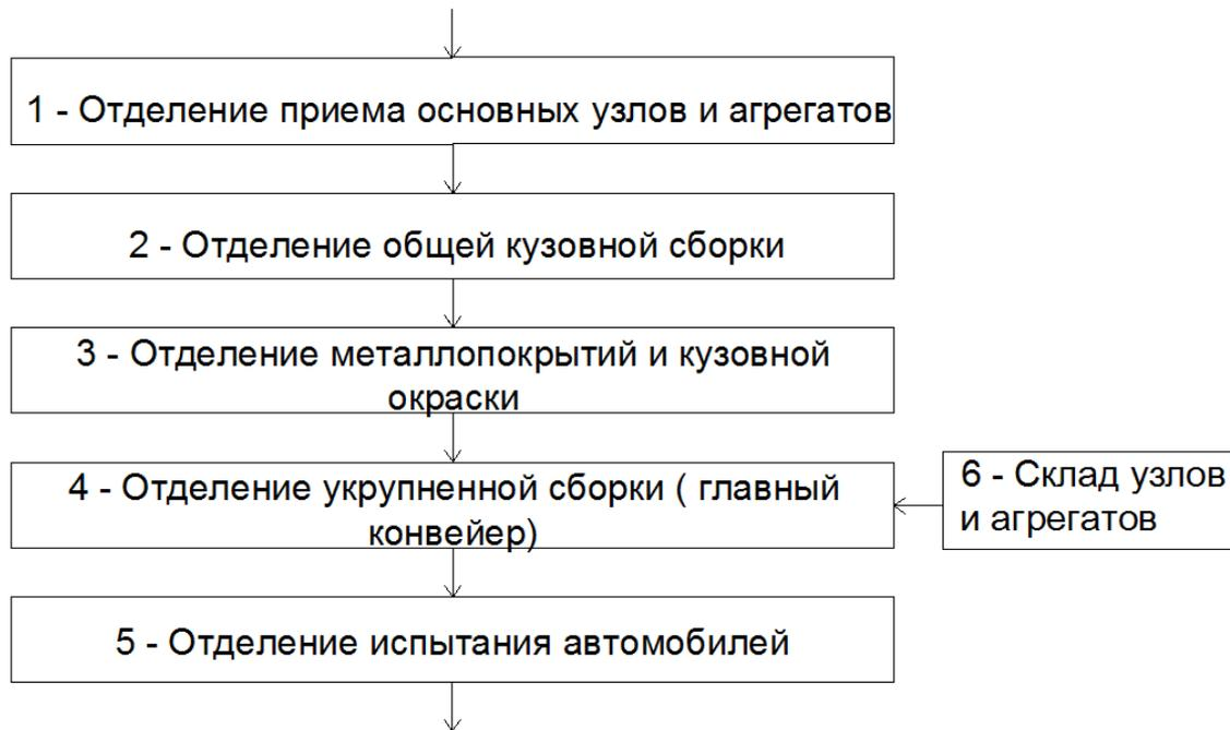
Рис. П.16. Схема технологических процессов главного корпуса автозавода
