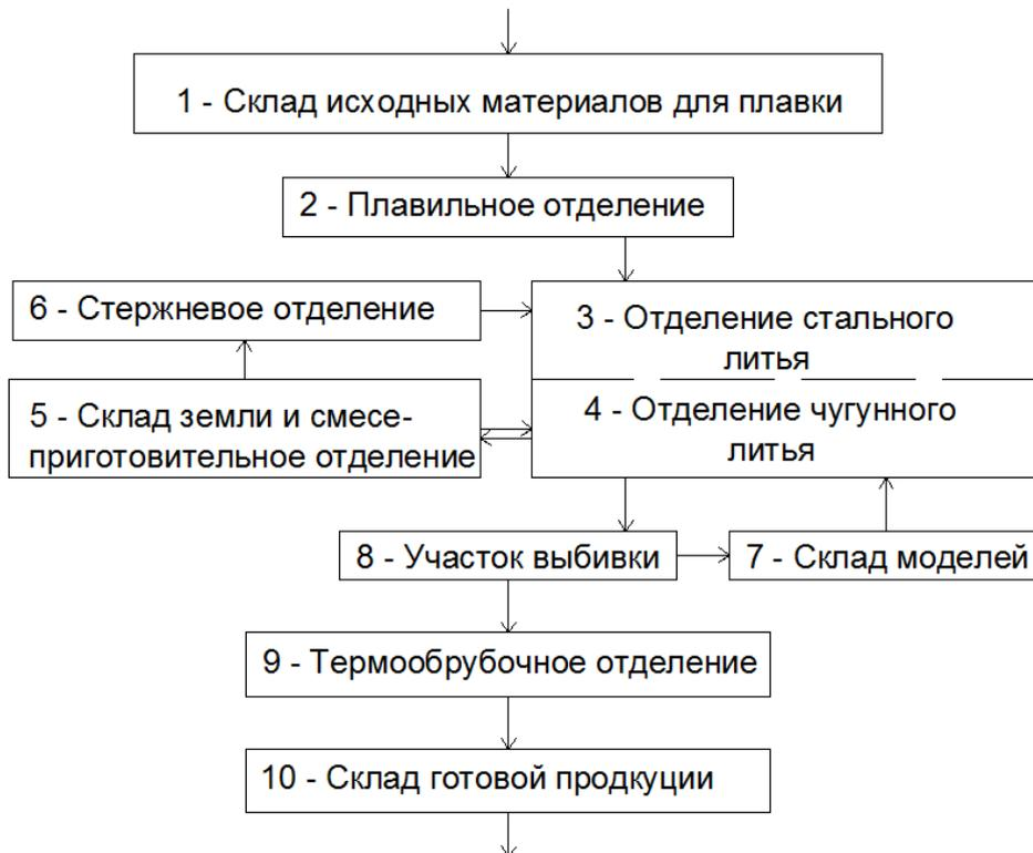
Рис. П.1. Схема технологических процессов литейного цеха
