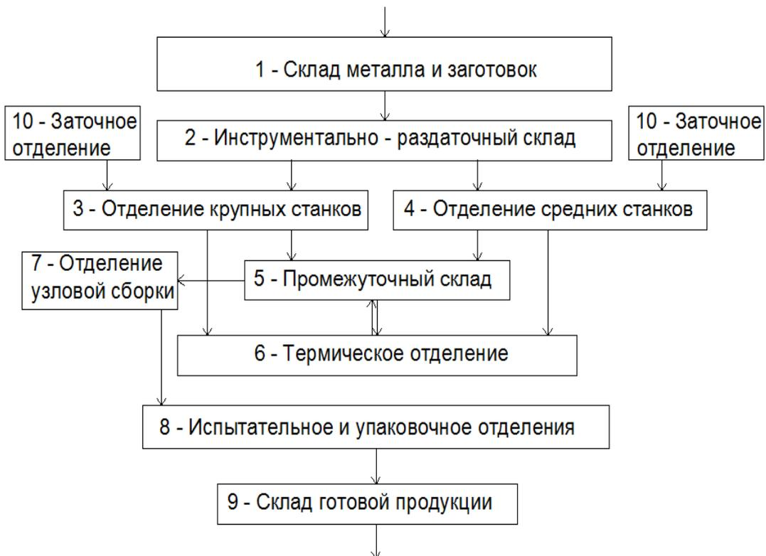
Рис. П.6. Схема технологических процессов механического цеха
