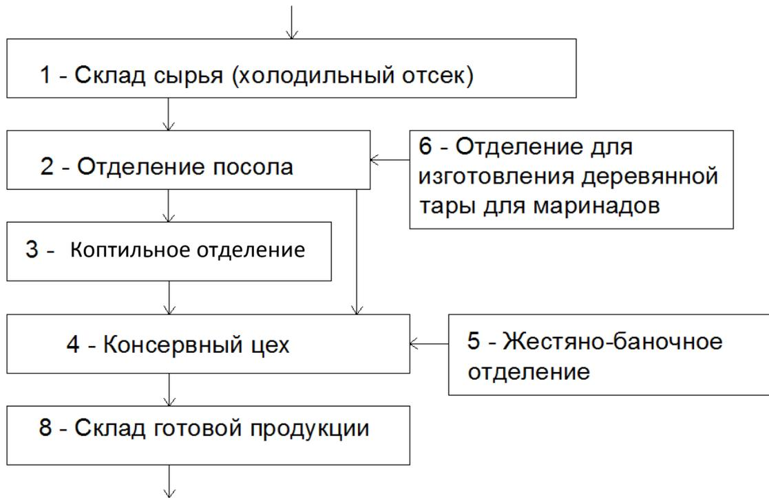
Рис П.26. Схема технологических процессов рыбозавода
