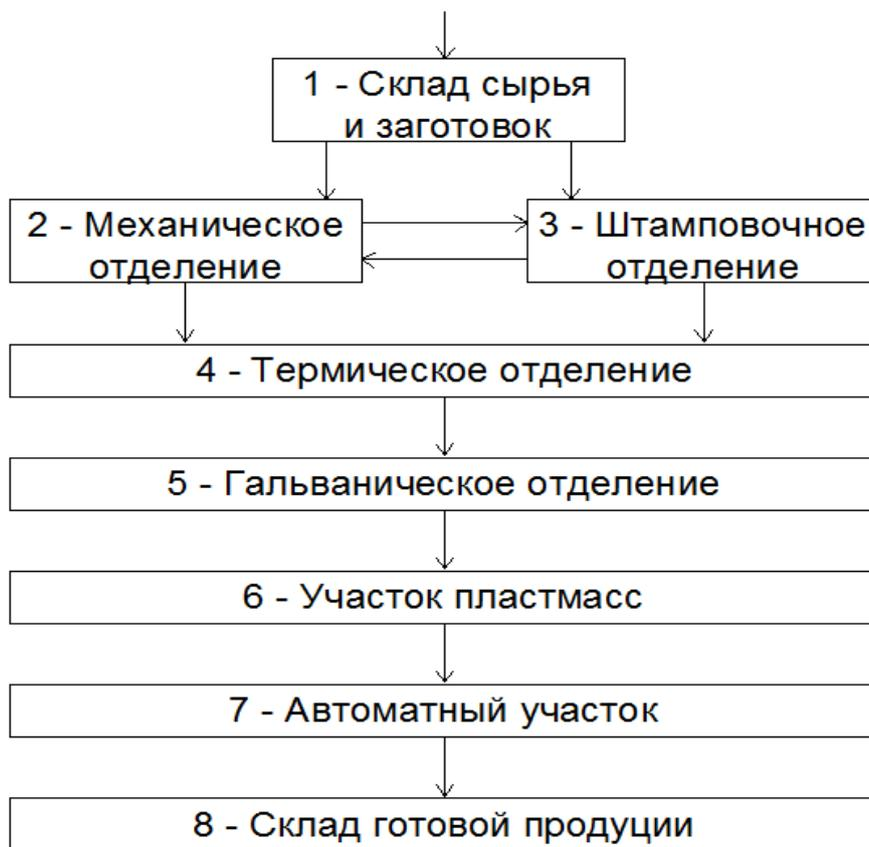
Рис. П.36. Схема технологических процессов заготовительного корпуса завода приборостроения
