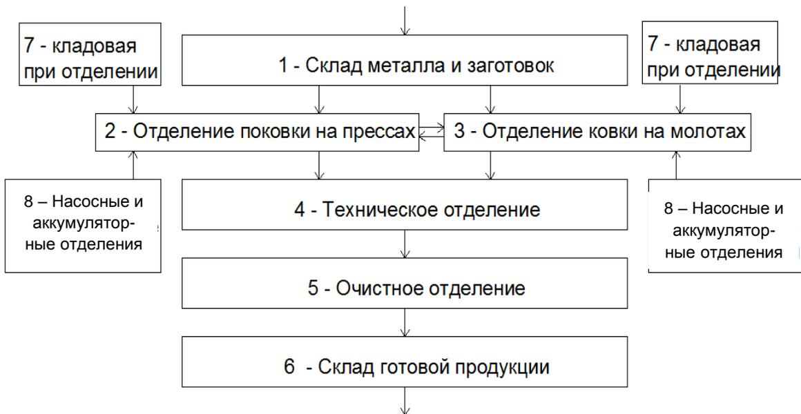
Рис. П.11. Схема технологических процессов кузнечного цеха
