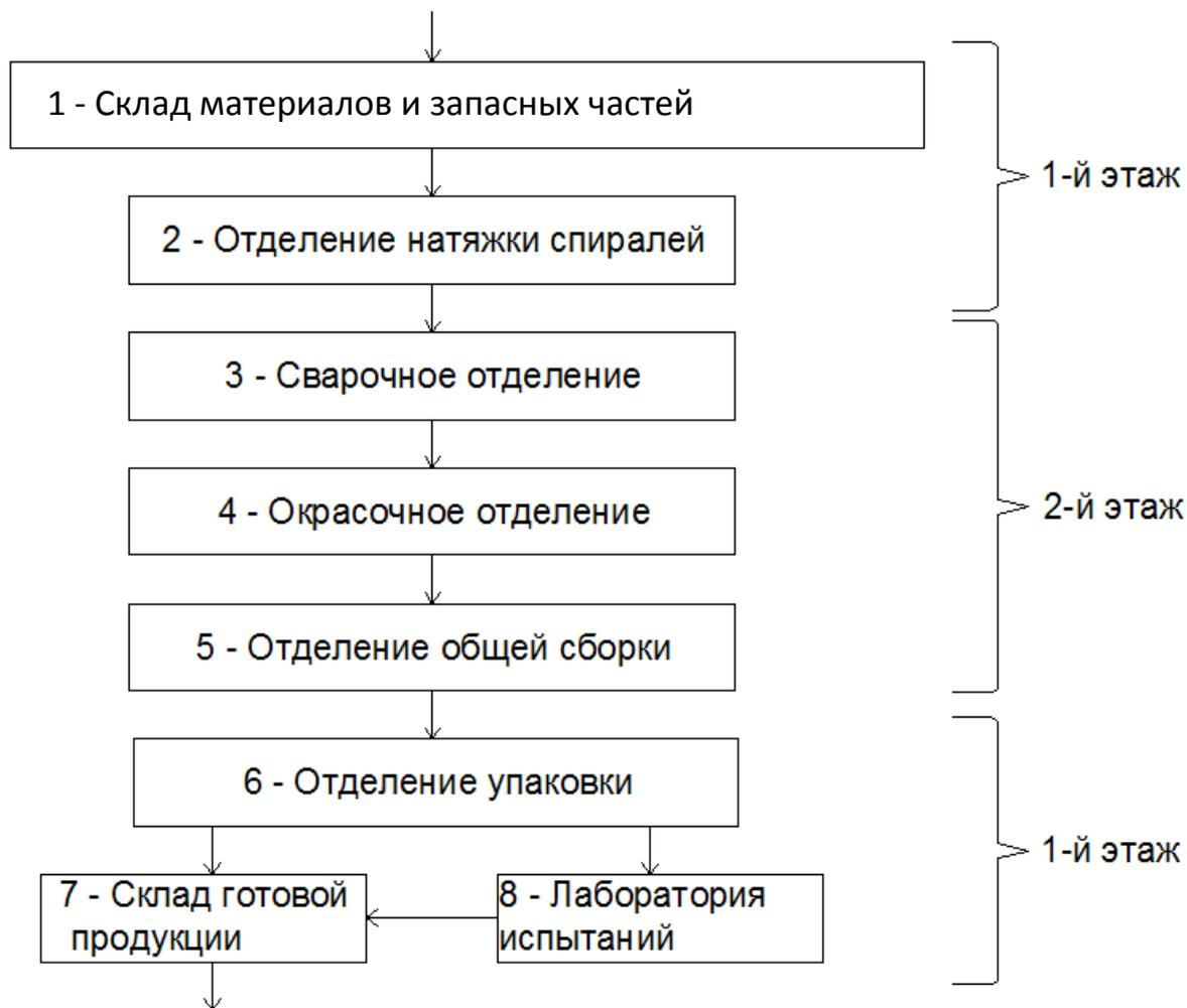
Рис. П.41. Схема технологических процессов главного корпуса завода электронагревательных приборов
