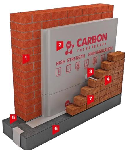
Рис. 6. Конструктивное решение наружной стены с утеплителем из экструдированного пенополистирола:
