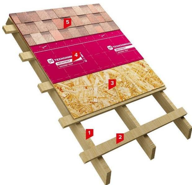
Рис. 20. Вариант устройства покрытия скатной крыши с холодным чердаком:
