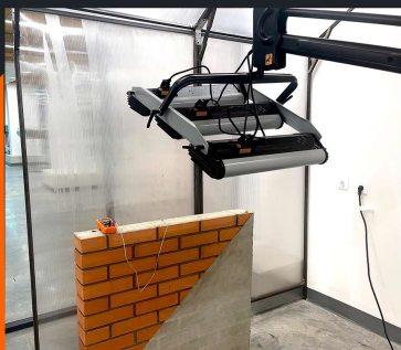
Мобильная инфракрасная коротковолновая сушильная установка IR 3W
